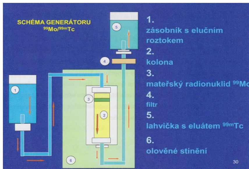
Obrázek 13 Schéma molybden-techneciového generátoru 15
