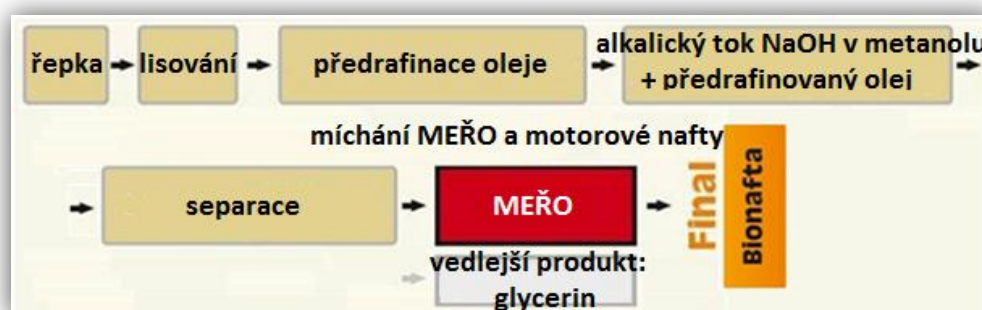
Obrázek 3 Schéma technologie výroby bionafty II. generace
