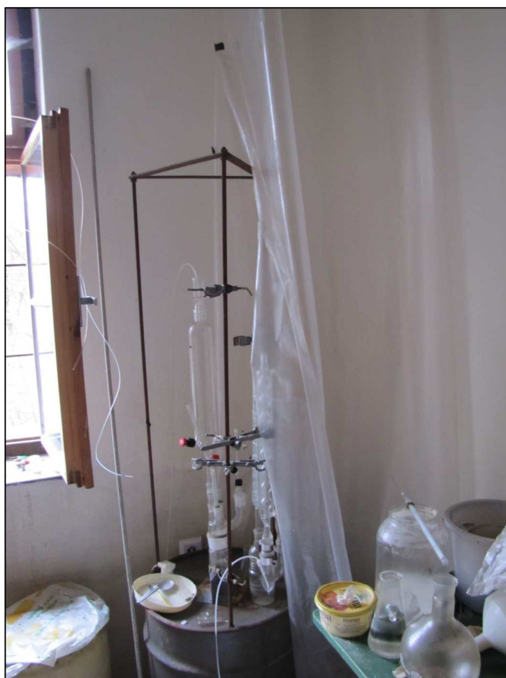
Destilační kolona, která sloužila k výrobě vysoce procentní kyseliny dusičné
