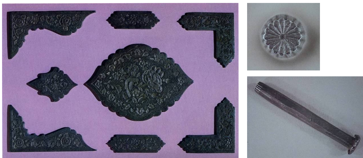
Obr. 32 Ocelové štočky pro slepotisk a zlacení, Persie, polovina 19. století 95
