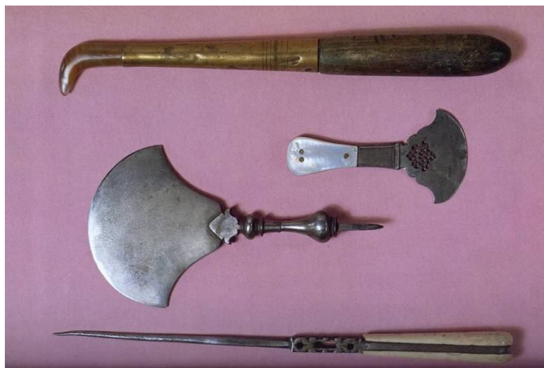
Obr. 35 Perské nářadí: leštítko s achátem, tenčící nože a šídlo vykládané perletí, 19. století 98
