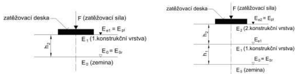
obr. 2 Určení ekvivalentních modulů přetvárnosti
