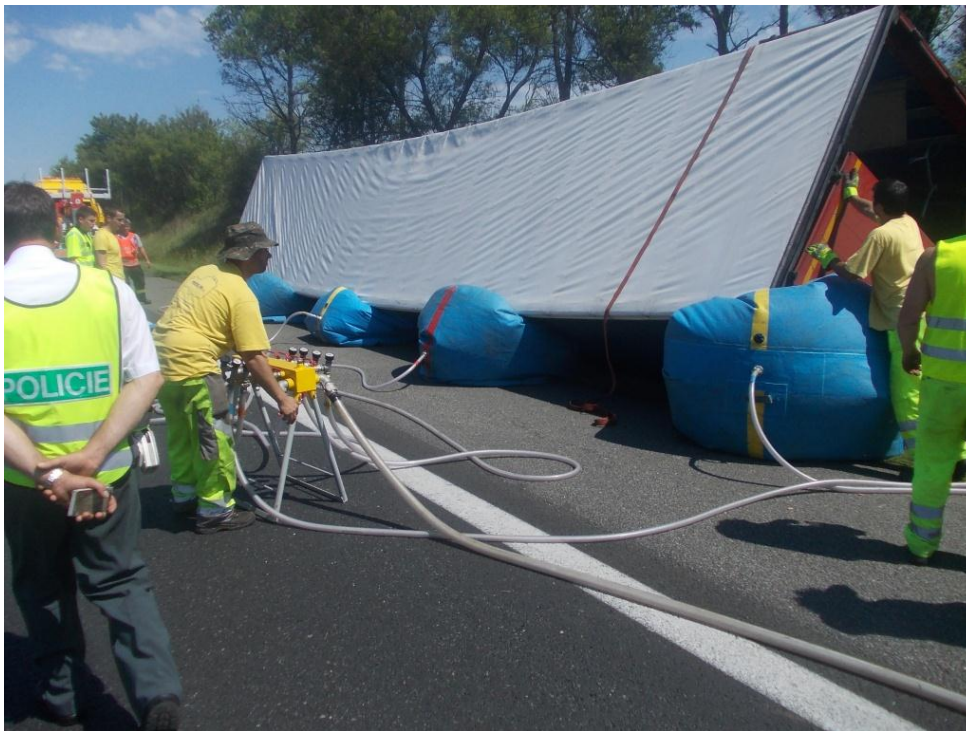
Obrázek 15 - Vyprošťování převrácené návěsové soupravy pomocí speciální technologie za použití vyprošťovacích vaků
