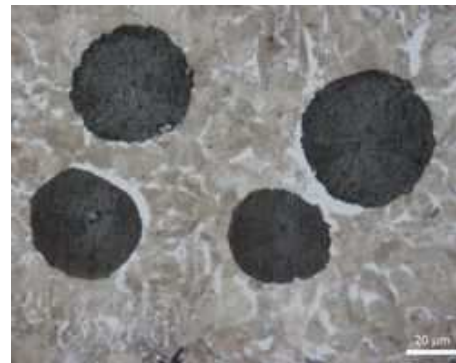
Obr. 8 Guľôčkový grafit, zv. 1000x [4]
