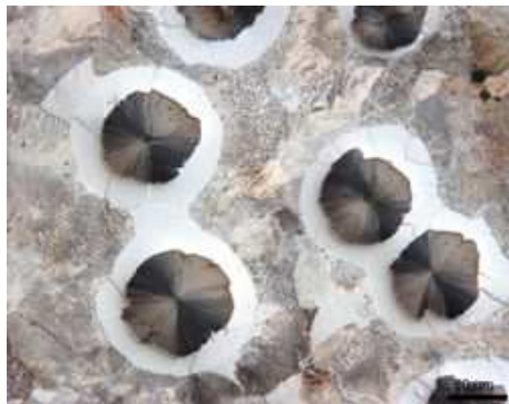
Obr. 7 Guľôčkový grafit, zv. 500x [4]
