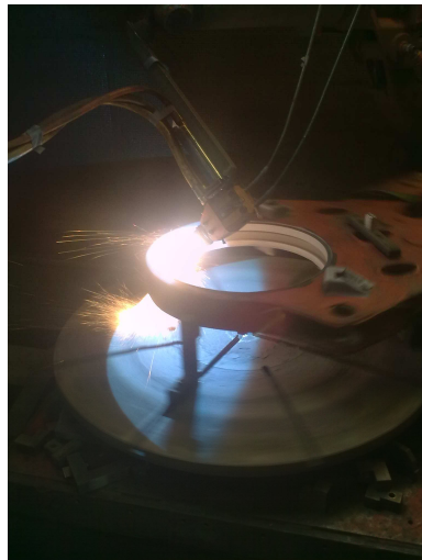
Obr. 11: Nástřik vnější drážky ložiska
