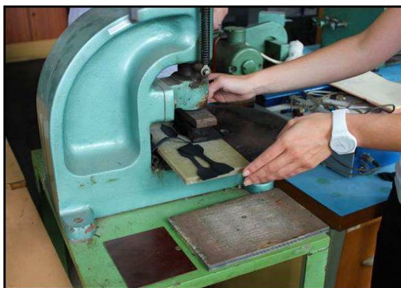
Obr. 8: Vysekávanie vzoriek gumárenských zmesí
