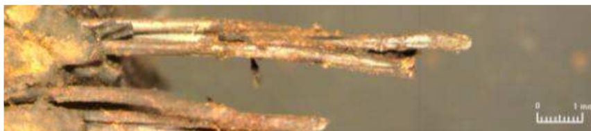
Obr. 11: Rozsah korózneho pôsobenia na vytrhnutých kordoch oceľokordového nárazníka [4]
