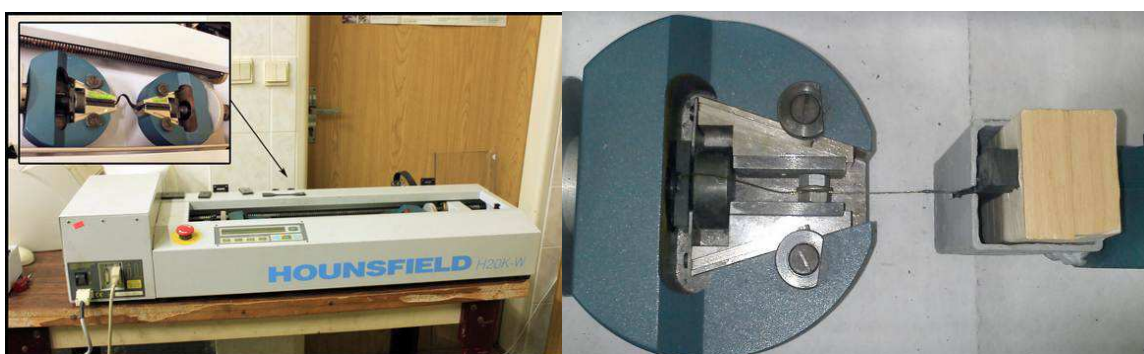
Obr. 10: Skúšky v ťahu: a) elastomérov, b) zalisovaných ocel'ových kordov
