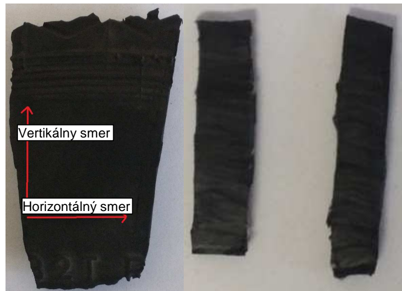
Obr. 3: Názorná ukážka smerov rezu a tvaru vzoriek (vpravo)
