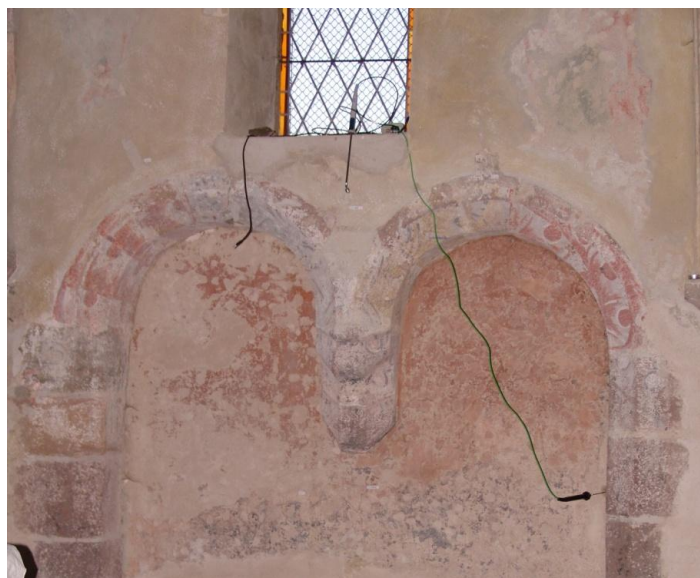
Obrázek 1 – Polohy čidel kontaktního měření (vlevo „T vzduchu + „RH vzduchu, uprostřed „T silná zeď, vpravo „T úzká – kout sedile), J. Pašek
