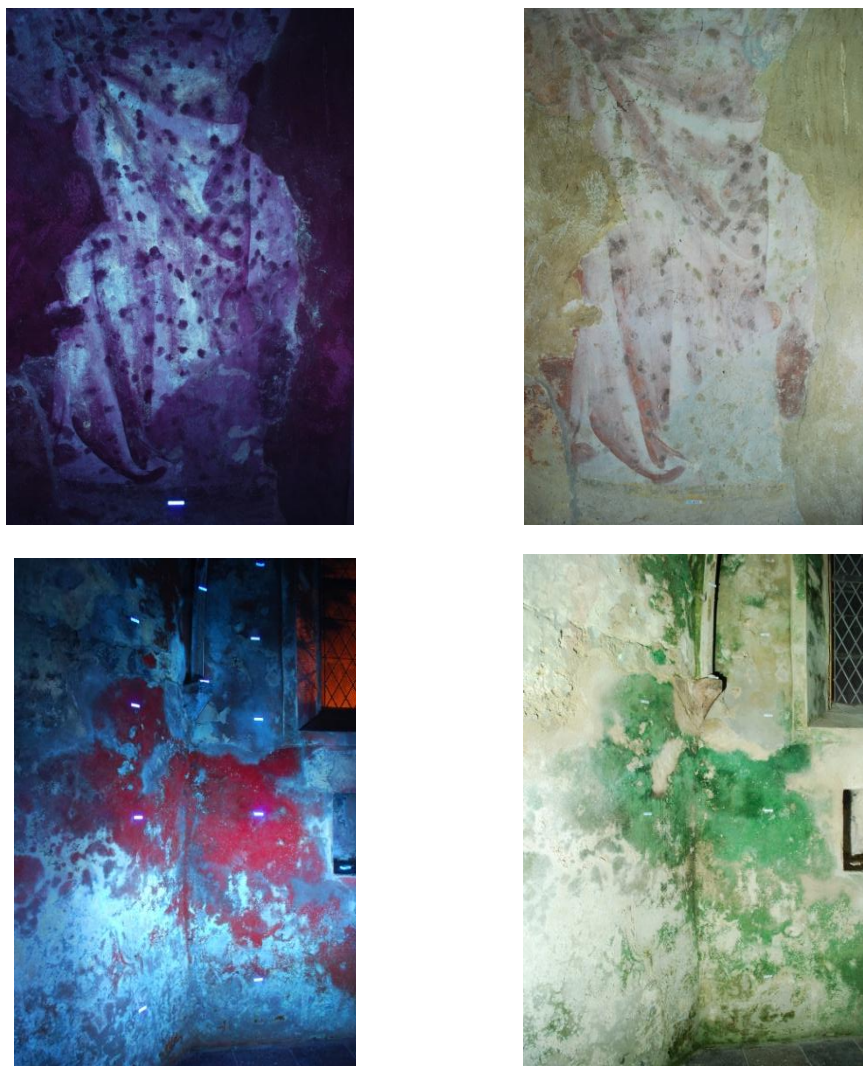
Obrázek 29, 30, 31 a 32 – Srovnání snímků fotografovaných v různé spektrální oblasti světla, na jižní a severozápadní části presbytáře. Vlevo snímek v UV světle, vpravo snímek ve viditelném světle
