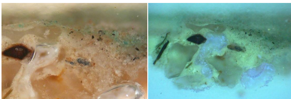
Obrázek 20 a 21 – Vzorek V15, měďnatá zeleň malachitového typu (D. Pechová)
