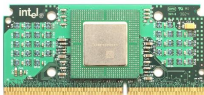
Obrázek 25 - První Celeron postavený na jádře Covington z Pentia II [24]
