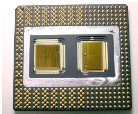
Obrázek 19 - Intel Pentium Pro, L2 cache jako samostatný čip [18]
