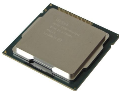
Obrázek 47 - Intel Core i7 Ivy Bridge [46]
