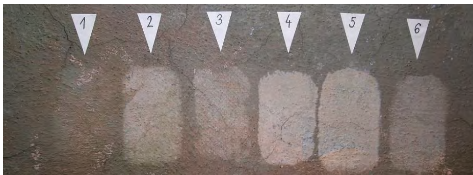
Obrázek č. 33: Zkoušky odstraňování přemaleb v pozadí nad postavou Sáry, lokalizace (viz. Příloha 10.1. Fotodokumentace, Obr. 42,43, Příloha 10.2., Grafická dokumentace)
