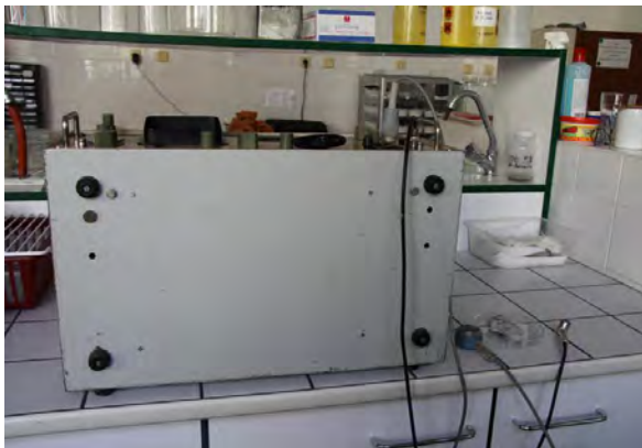
Obr. 82, 83 Měření vzorků omítek ultrazvukem
