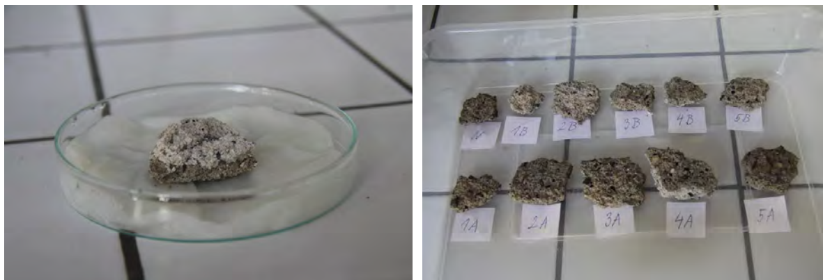
Obr. 84, 85 Měření nasákavosti vodou kapilárním vztlínáním
