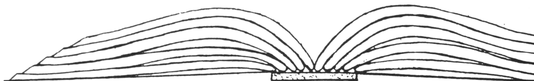
Obr. 2. Schéma otevřené knihy s neklíženým hřbetem s charakteristickým stupňovitým efektem u přední ořízky. (Conroy, T.: The Movement..., str. 22, obr. 33.)
