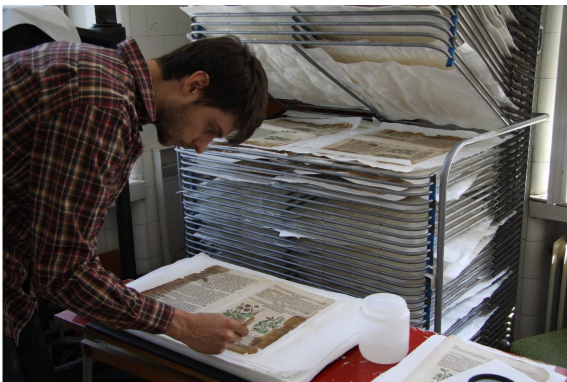
Obr. č. 40 Glejenie jednotlivých dvojlistov, priebeh reštaurovania
