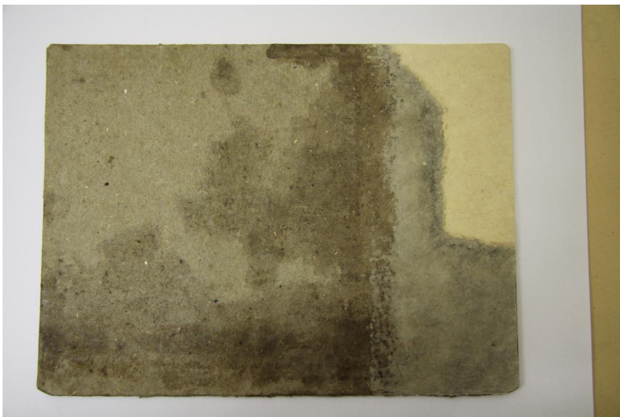
35. Opravená deska, doplněk z alkalické lepenky a přelep z japonského papíru
