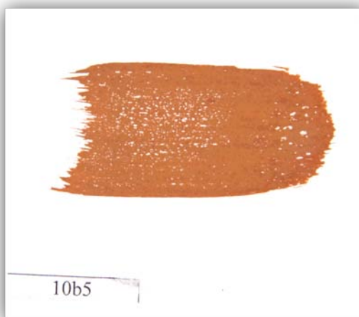
97. Obrázek: receptura (B) v lazurní podobě; požit přírodní štětec na izolované podložce; snímáno v denním rozptýleném světle
