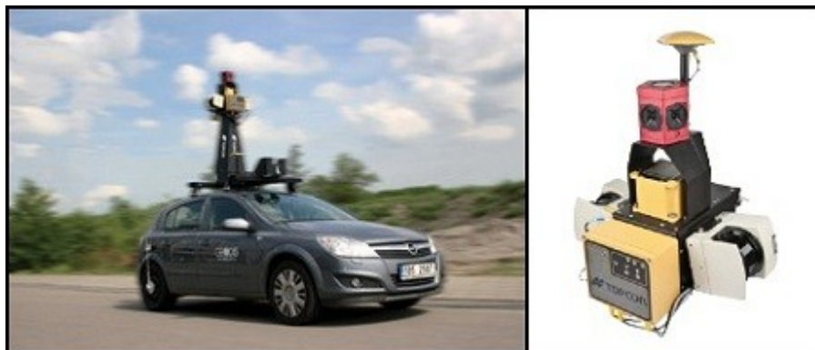
Obrázek č. 18: Základní konfigurace IP-S2 Topcon
