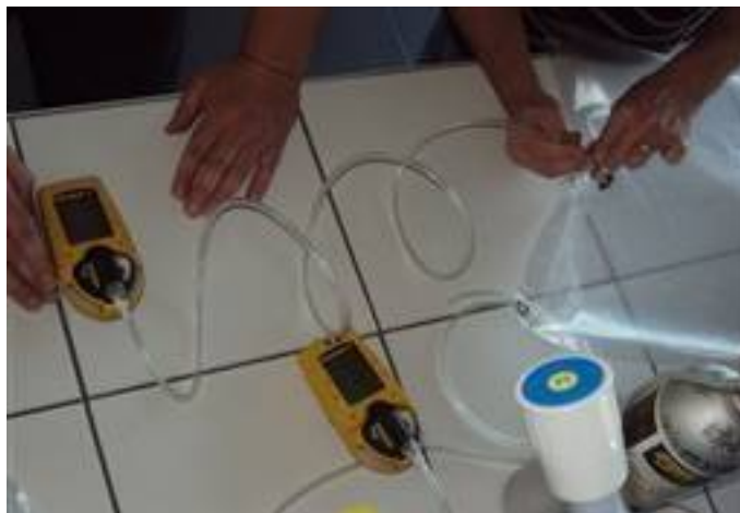
Obrázek 21 - Simulace měření přes odběrovou sondu
