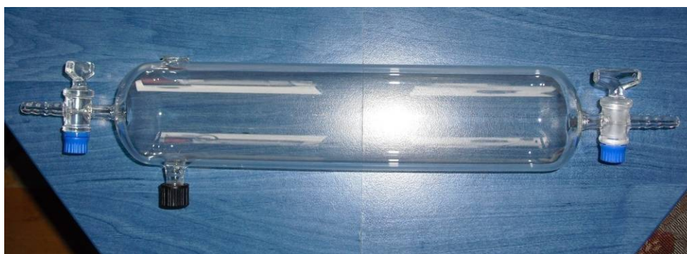
Obrázek 22 - Odběrová „myš“ upravená pro simulaci odběru ve volném prostoru
