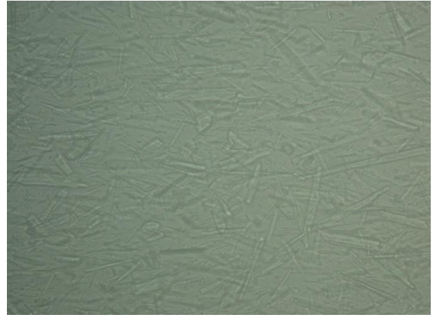
Obrázek 32: Povrch wollastonitu, OKP 5%, zvětšeno 20x
