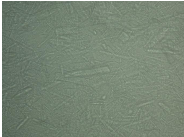
Obrázek 33: Povrch wollastonitu, OKP 10%, zvětšeno 20x
