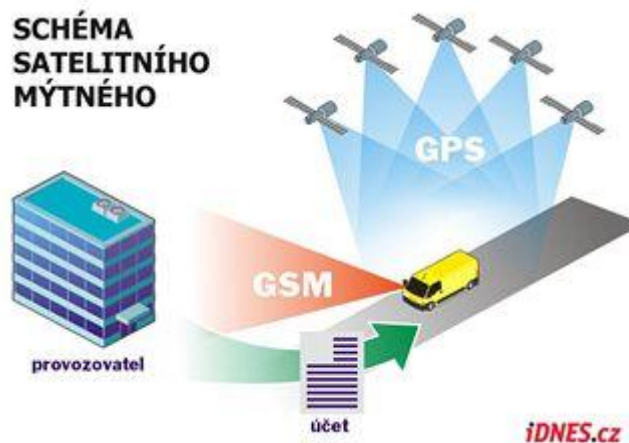
Obrázek č. 13 - Princip funkce satelitního mýtného systému
