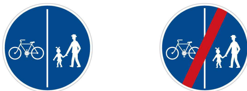
Obrázek 3: Dopravní značky č. C 9a "Stežka pro chodce a cyklisty" a č. C 9b "Konec stežky pro chodce a cyklisty"
