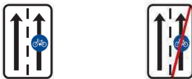
Obrázek 4: Dopravní značky č. IP 20a "Vyhrazený jízdní pruh" a č. IP 20b "Konec vyhrazeného jízdního pruhu"
