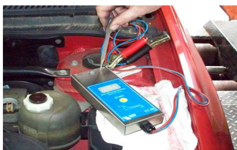
Obr. č. 11 – Kontrola bodu varu brzdové kapaliny
