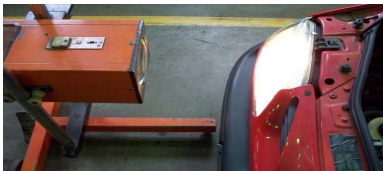
Obr. č. 16 – Seřizování světlometů pomocí regloskopu
