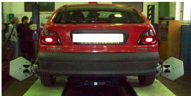
Obr. č. 14 – Automobil při kontrole geometrie
