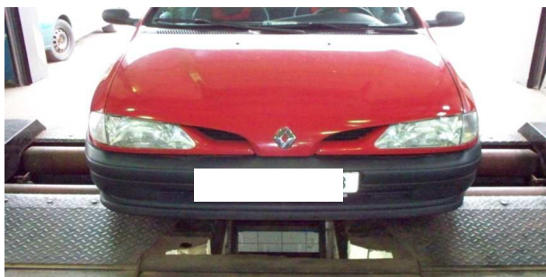
Obr. č. 12 – Umístění automobilu na pomaloběžné válcové zkušební brzd
