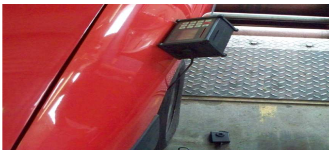
Obr. č. 13 – Umístění diagnostického zařízení pro kontrolu činnosti tlumiče
