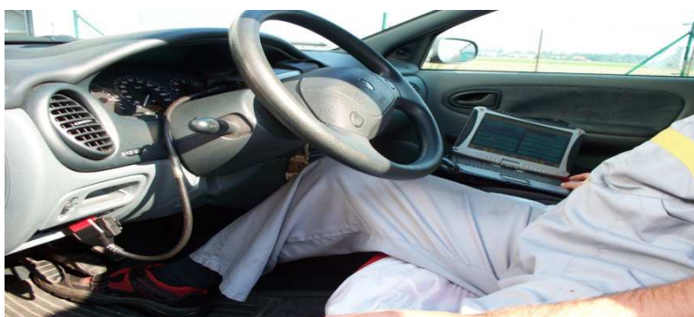
Obr. č. 15 – Propojení ECU s diagnostickým programem
