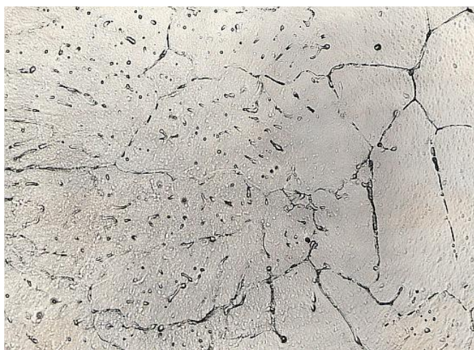
Obrázek 15 – základní struktura litého Al 99,5 E [10] 100x
