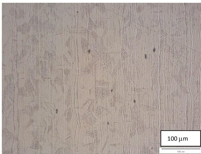
Obrázek 11 – základní struktura austenitické korozivzdorné oceli
