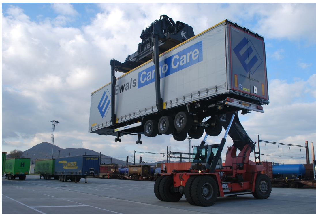
Obr. č. 6 Mega Huckepack návěs pro přepravu po železnici
