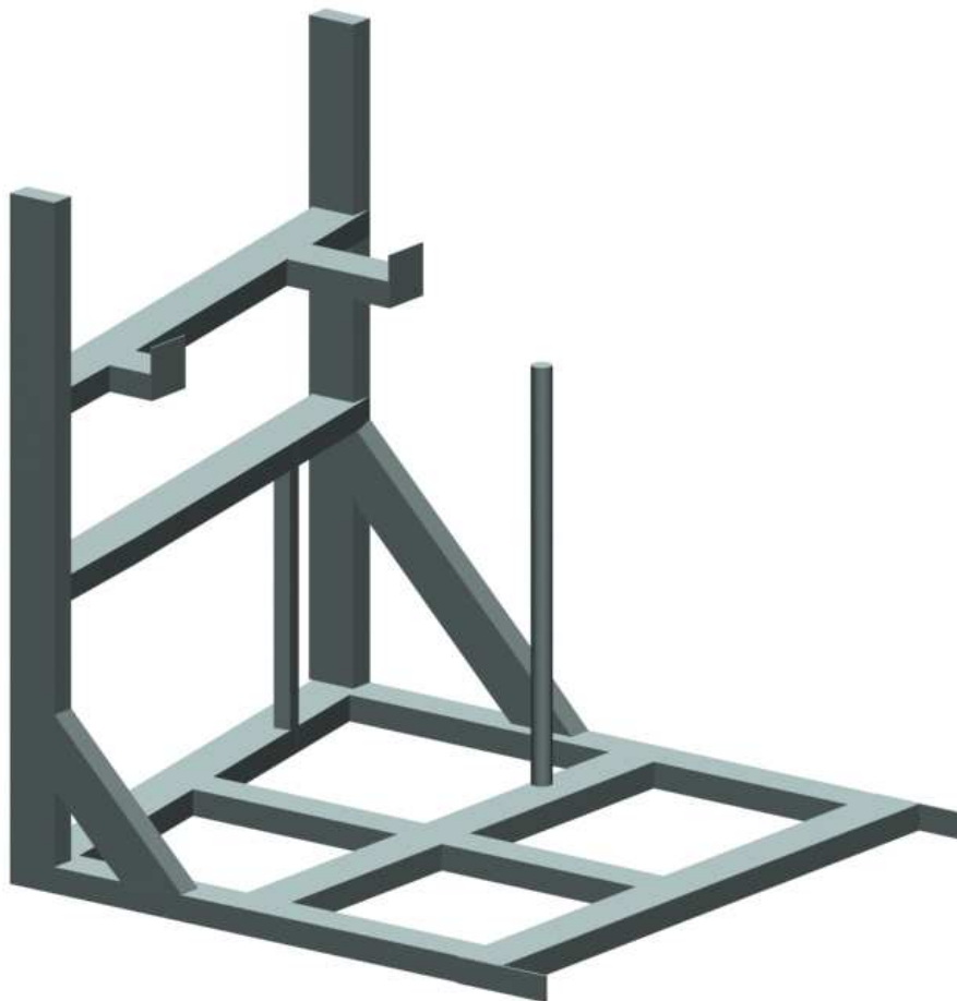
Obrázek č. 11 zobrazuje konstrukci spodního dílu přední části rámu
