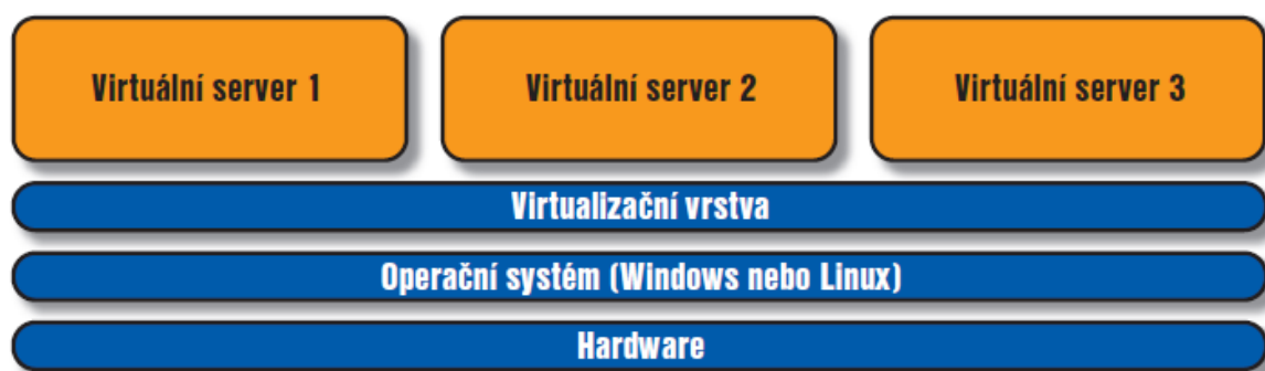
Obr. 4 – Schéma virtualizace na úrovni operačního systému, zdroj: [1]
