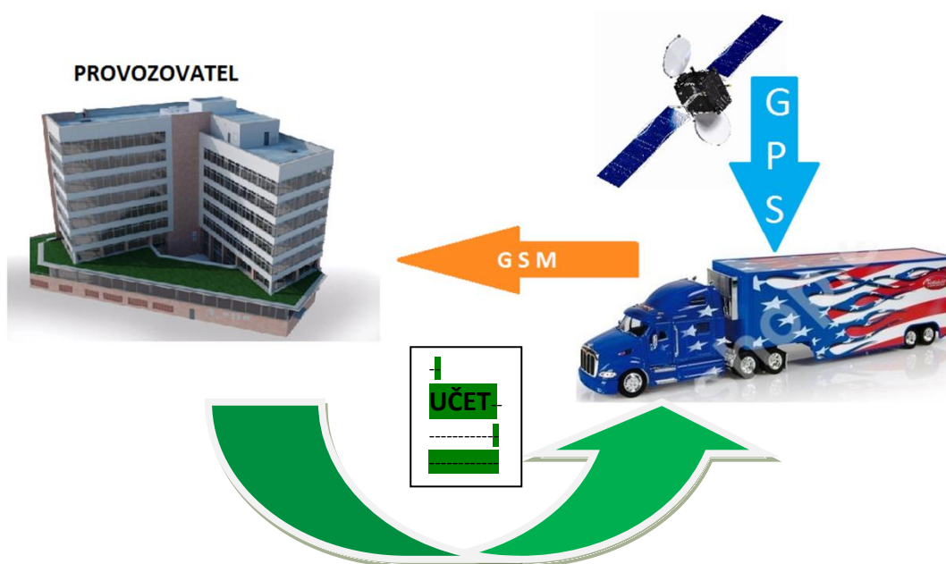
Obrázek č. 27 – Schéma satelitního mýtného systému
