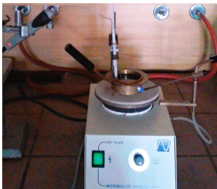
Obr. 2 Přístroj pro stanovení bodu vzplanutí v otevřeném kelímku
