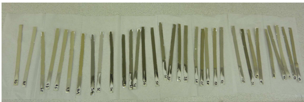
Obr. 14 Ukázka 33 připravených vybraných zkušebních proužků z testů motorového oleje vozů řady 810 [vlastní foto]
