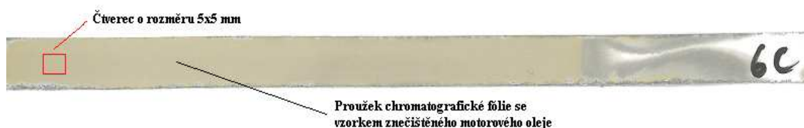
Obr. 19 Naskenovaný proužek chromatografické fólie se vzorkem znečištěného motorového oleje [vlastní obrázek]
