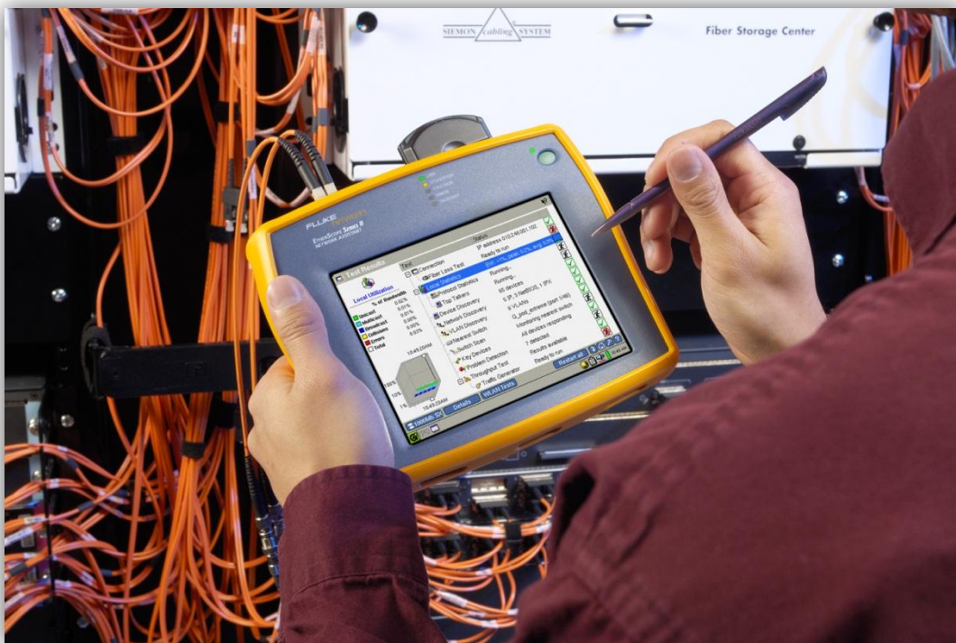
Obrázek 12 – Diagnostický nástroj Fluke Networks ES2 EtherScope™ Series II Network Assistant
