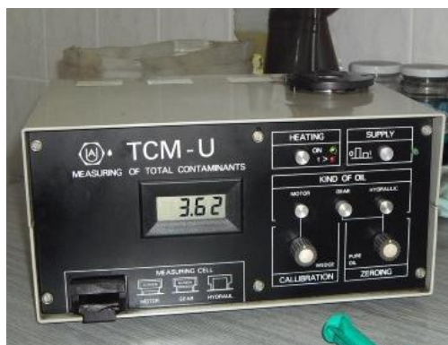
Obr. 3 Přístroj TCM-U [foto autor]
