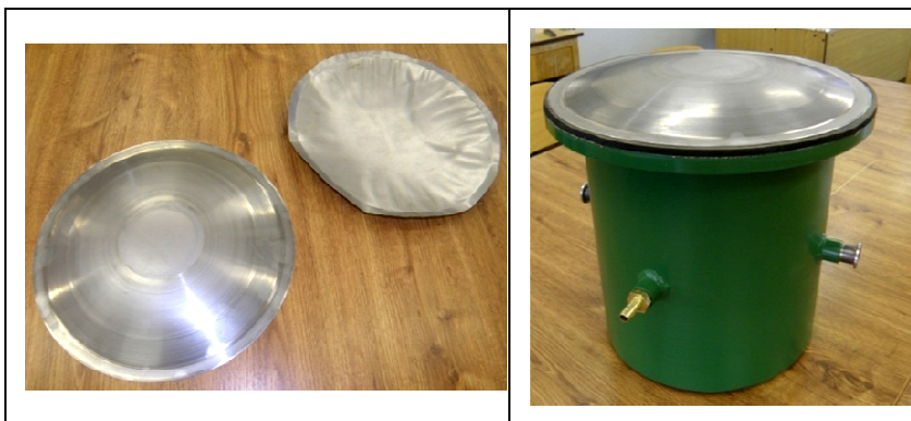
Obr. 11: Experimentální vzorek vrchlíku umístěný na zkušebním zařízení.
