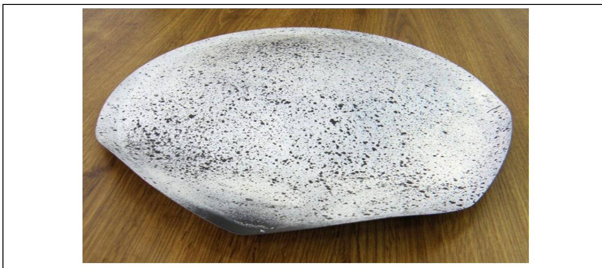
Obr. 51: Deformovaný experimentální vzorek s povrchovou úpravou pro měření deformací systémem ARAMIS.
