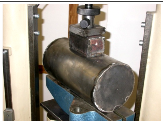
Obr. 18: Experimentální model válcové skořepiny.
