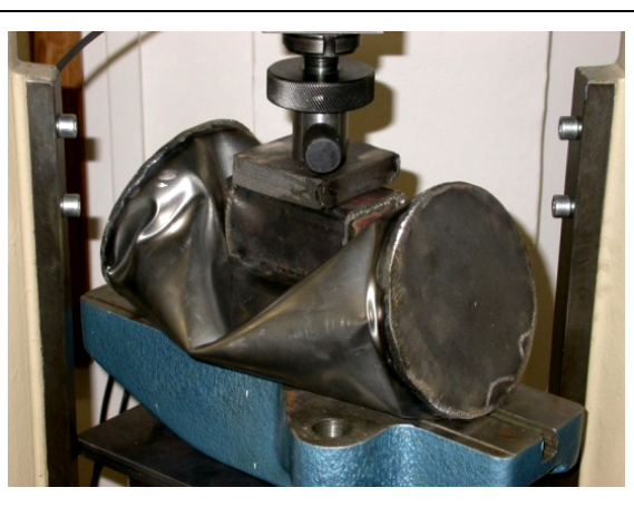
Obr. 20: Závěr experimentu při u_y=65 \text{ mm}
