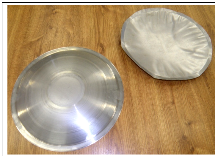
Obr. 48: Původní a deformovaný experimentální vzorek vrchlíku.
