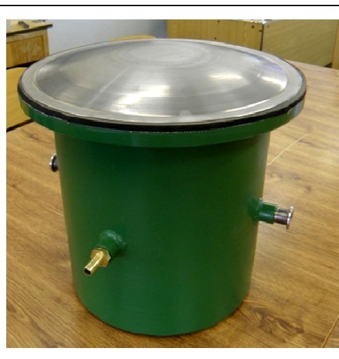
Obr. 49: Experimentální vzorek vrchlíku umístěný na zkušebním zařízení.
