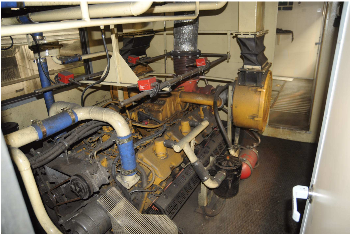
Obr. 2 – Spalovací motor Caterpillar ve strojovně motorového vozu
