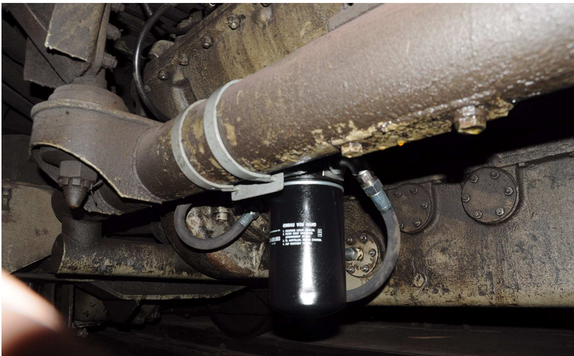
Obr. 15 – Pohled na filtraci převodovky H 750 M motorového vozu 851 032
