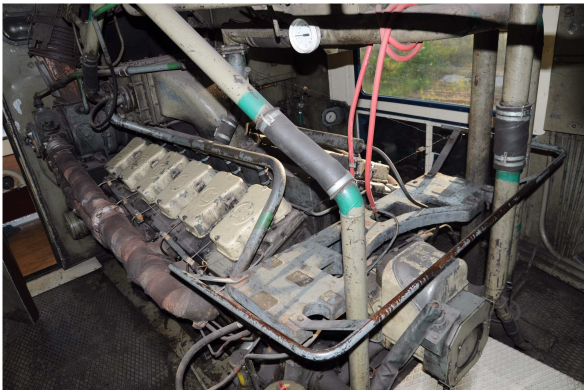
Obr. 4 – Spalovací motor KS 12 V 170 DR páté série ve strojovně historického motorového vozu 851 032
