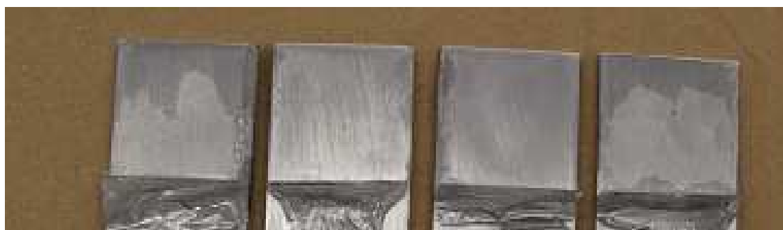
Obr. 25 Vzorky broušené brusným papírem o drsnosti P400 po zkoušce tahem ve smyku
