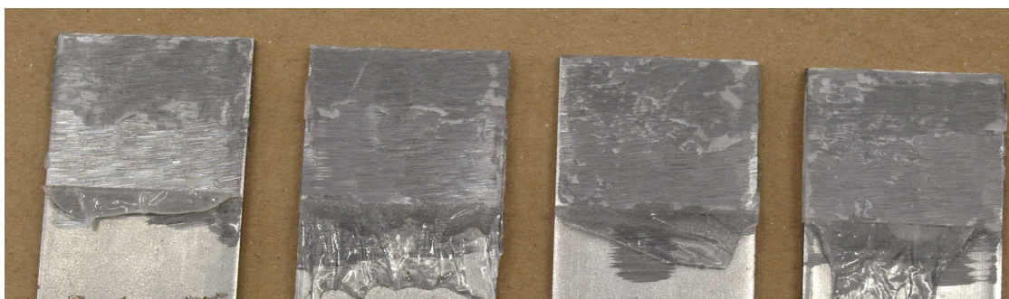
Obr. 22 Vzorky broušené na kotoučové brusce po zkoušce tahem ve smyku
