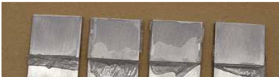
Obr. 24 Vzorky broušené brusným papírem o drsnosti P120 po zkoušce tahem ve smyku
