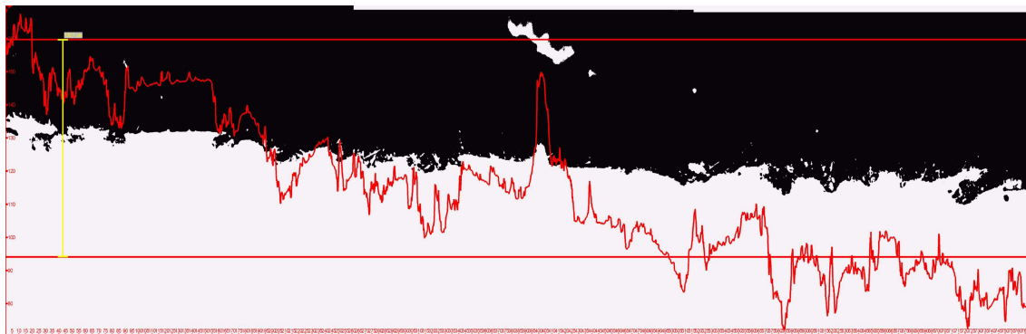
Obr. 32 Binarizovaný povrch vzorku broušeného kotoučovou bruskou
