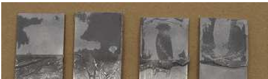
Obr. 21 Vzorky tryskané keramickým abrazivem po zkoušce tahem ve smyku
