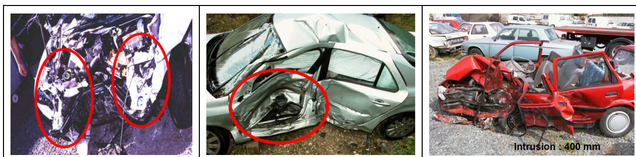
Obr. 39 Ukázky důsledků nekompatibility mezi vozidly – zleva: nezdeformované podélníky; vážná intruze v boku vozidla způsobená lokální tuhostí narážejícího vozidla; přetížený prostor pro posádku.
