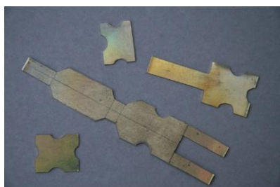
10 - Vyříznuté a zarovnané části knižního kování
