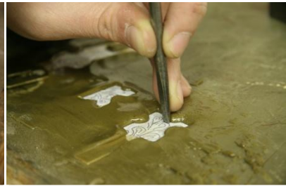
18 - Vytepání obrysů dekoru pomocí tzv. punznů
