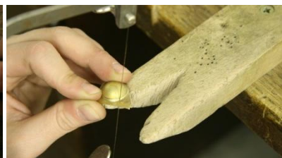
3 - Vyřezání přesného tvaru pomocí lupénkové pilky
