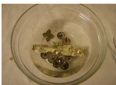
1 - Odmaštění kovových prvků v etanolu
