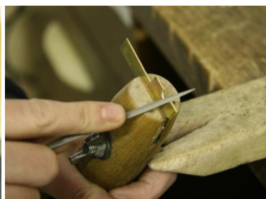
9 - Jemné pilování pomocí jehlových pilníků
