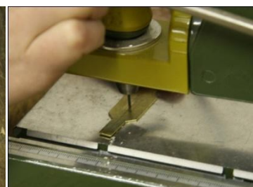
12 - Vyvrtání otvoru mini vrtačkou upevněnou ve stojanu
