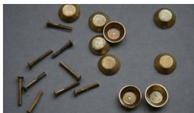
10 - Pukly a hřebíčky připravené k pájení
