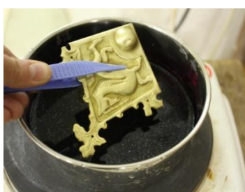
2 - Ponor vyčištěného kování do patinovacího roztoku
