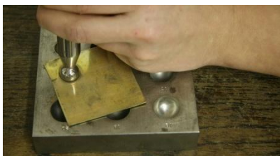
1 - Vyklepání tvaru pukly na profilovací desce
