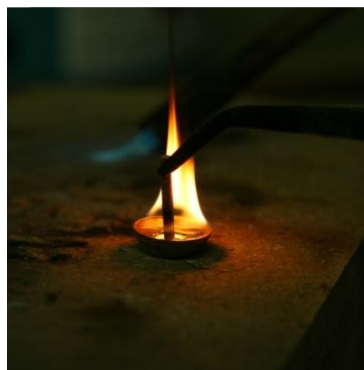
15 - Opětovné roztavení cínu pro lepší spojení hřebíku s puklou
