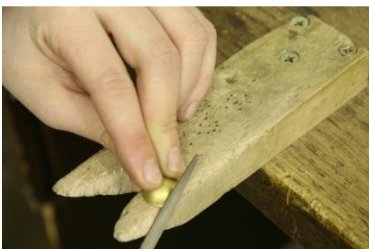
4 - Zapilování obvodu jehlovým pilníkem
