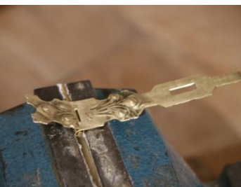
26 - Zatažení pantu pomocí svěráku
