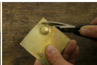
2 - Vystřížení hrubého tvaru nůžkami na plech
