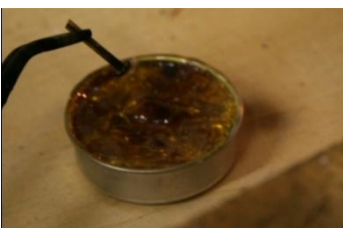
11 - Namočení rozžhavené hlavičky hřebíku do kalafuny
