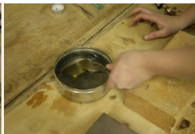
3 - Chlazení vyžíhaného plechu ve studené vodě
