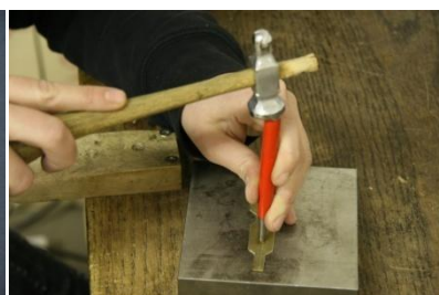
11 - Označení místa pro vyvrtání otvoru pomocí důlčíku
