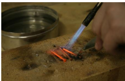
7 - Žihání hřebíků (následuje chlazení ve studené vodě)
