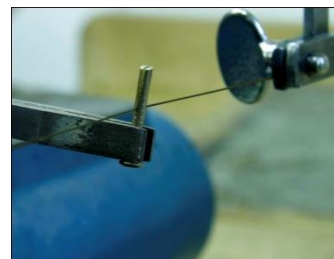
9 - Rozříznutí nožičky hřebíku na polovinu
