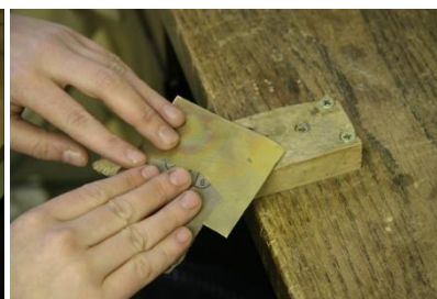
5 - Úprava povrchu smirkovým papírem
