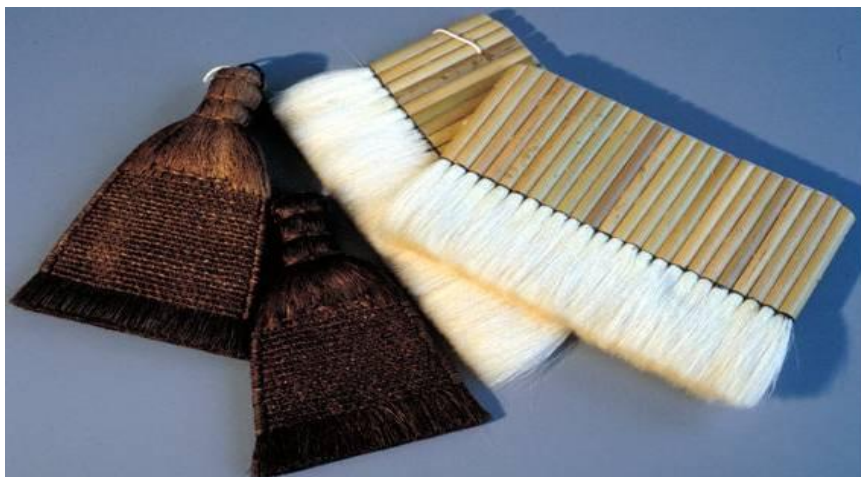
Obr. 260 Čínské štětce pro montáž svitků- vpravo štětec z kozích chlupů, vlevo z kůry palmy 472
