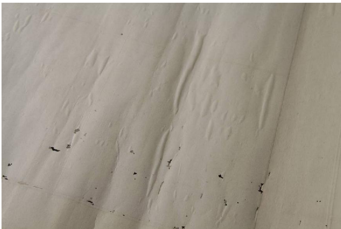
Obr. 160 Puchýře vzniklé po určité době na závěsném svitku z důvodu použití nedostatečné konzistence škrobového lepidla při lepení dublážových vrstev papíru 339
