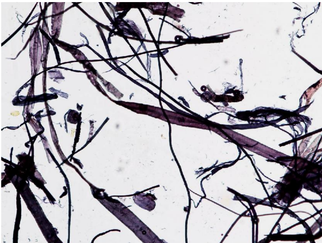
Obr.6 Vzorek 3 s vlákný jehličnanové buničiny a rýžové buničiny (pokožkové a parenchymatické buňky), vybarveno Herzbergovým roztokem (zvětšeno 100x)
