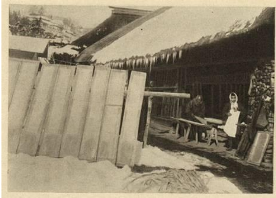
Obr. 116 Dobová fotografie japonské papírny. Archy papíru schnou a zároveň se bělí v zimním slunci přihlazené na dřevěných deskách. 201
