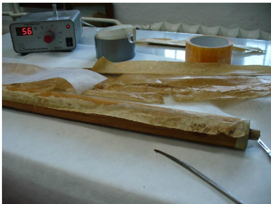
Obr. 49 Demontáž partií lepených klišem pomocí horké páry
