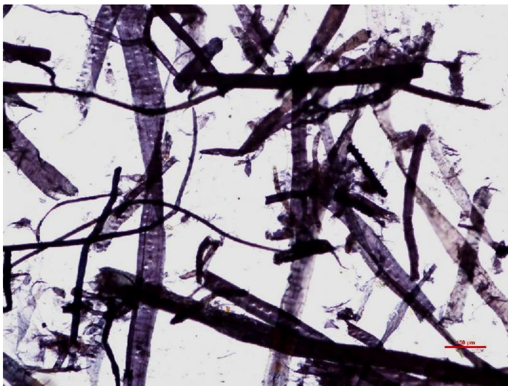
Obr.1 Vzorek 1 s převažujícími vlákny jehličnanové buničiny, vybarveno Herzbergovým roztokem (zvětšeno 100x)
