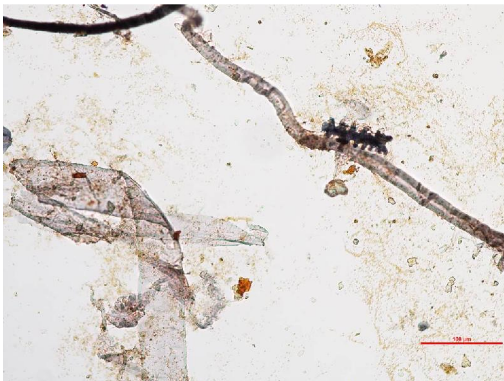
Obr.2 Vzorek 1 vybarveno Graffovým "C" roztokem, modrá pokožková buňka, pravděpodobně rýžová (zvětšeno 200x)
