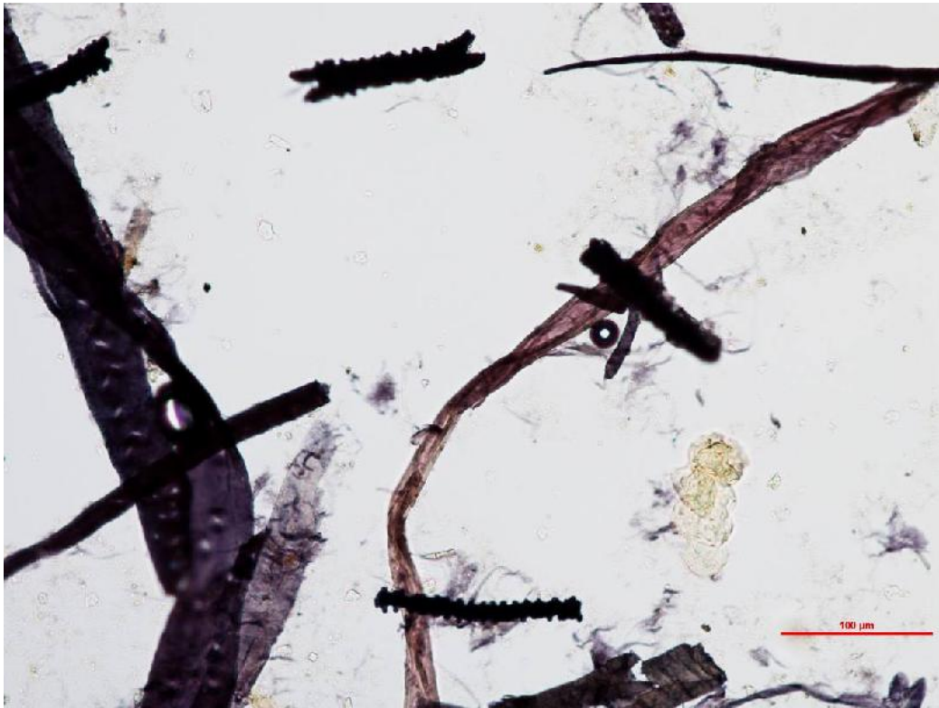
Obr.3 Vzorek 1 s vlákný jehličnanové buničiny, bavlny a pokožkové buňky rýžové slámy, vybarveno Herzbergovým roztokem (zvětšeno 200x)
