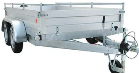
VZ-31 B2 v provedení s hliníkovými bočnicemi a relingem
