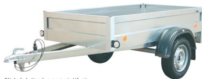
Přívěs řady Handy s masivní „V“ ojí
