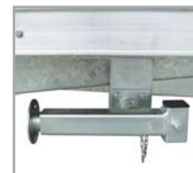
Možnost zadních a předních vysouvatelných podpěrných noh
