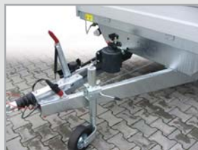
Ruční ovládání hydrauliky u přívěsu Atlas
