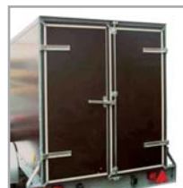
Detail dvoukřídlových dveří u překližkového přívěsu
