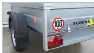
Detail praktického skupinového osvětlení s možností sklopení zadního čela nejen u přívěsů Handy
