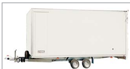
Hliníková skříň na podvozku DONA s 10" koly pro nižší těžiště přívěsu
