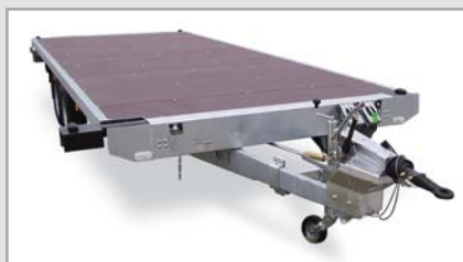
Přívěs Dona s polohovacími rameny pro přepravu prázdných ISO a námořních kontejnerů
