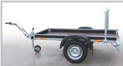
Nebzděný přívěs VZ-23 plato se zapojením na oko DIN 40
