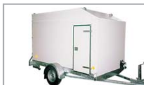
Bílá překližková skříň na podvozku VZ-31 B1 s bočními dveřmi a skosením pro efektivnější proudění větru
