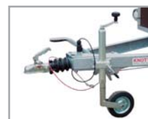
Detail nájezdové brzdy a opěrného kolečka
