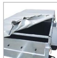
Detail relingu, předního otevíracího čela a plachty na překrytí u přívěsů NP
