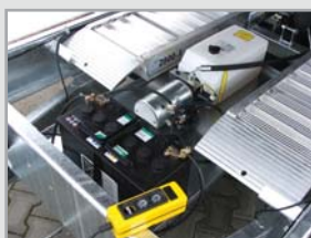
Elektrické ovládání hydrauliky u přívěsu Atlas
