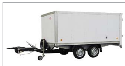
Hliníková skříň na podvozku VZ-33 s výškově stavitelnou ojí
