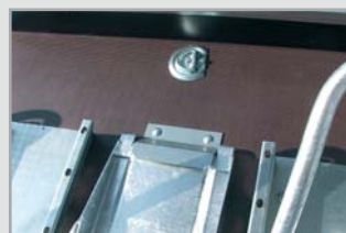
Detail kotvicí misky a uchycení nájezdu mezi lyžinami
