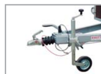
Detail nájezdové brzdy a opěrného kolečka
