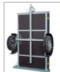
Zatahovací oj u nebrzděných přívěsů VZ-18, VZ-21, VZ-23
