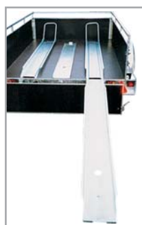
Přívěs VZ-26 s namontovanými nájezdy pro přepravu motocyklů
