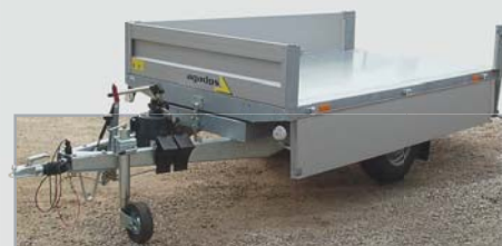
Sklopné a odnímatelné bočnice a sloupky u všech typů
