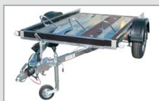
Brzděná varianta v základní výbavě s opěrným kolečkem
