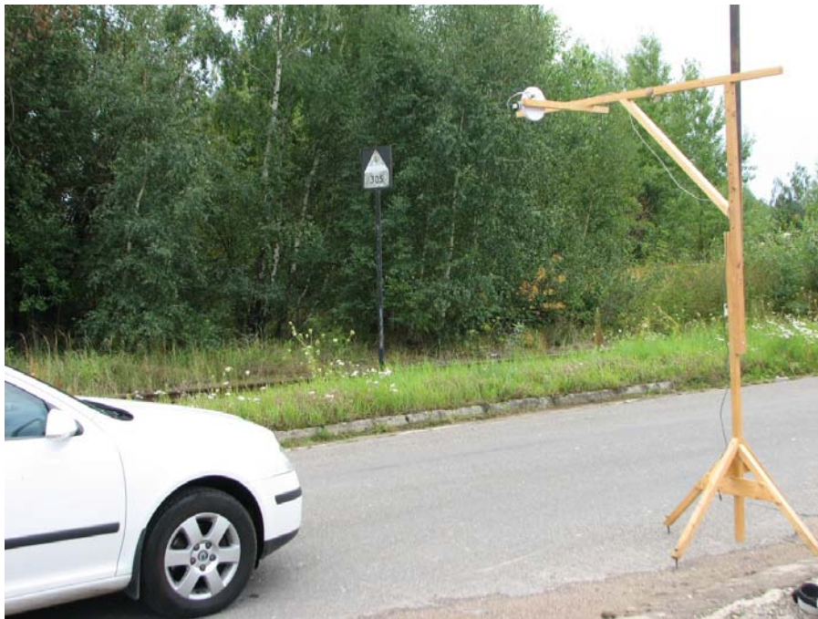
Obrázek 8.9 – Situace umístění sensorové jednotky detekce vozidel při měření
