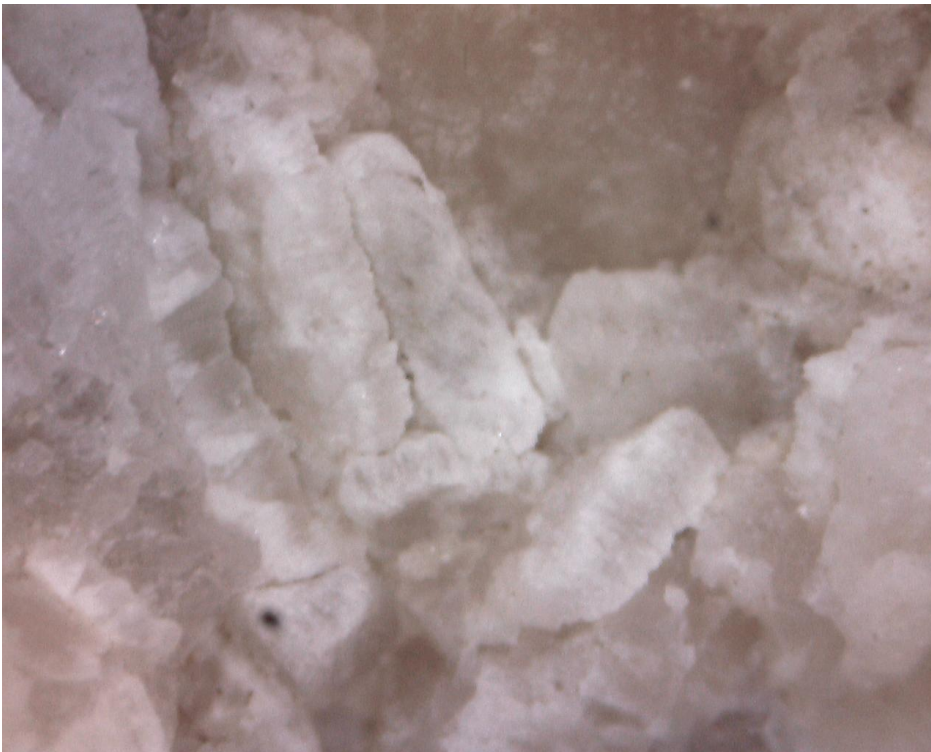
Obr. 33. Zvětšení 250x, po omytí tlakovou vodou. Povrch je zcela čistý, jsou patrné ztráty některých schránek živočichů a mezischránkové kalcitové výplně.
