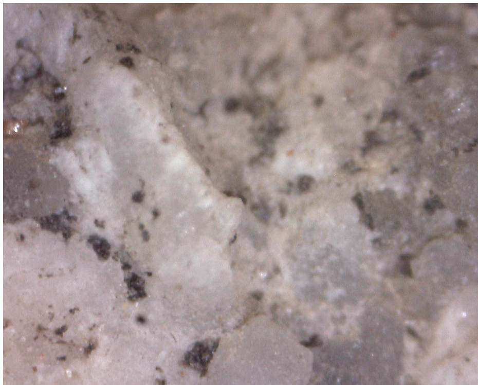
Obr. 29. Zvětšení 250x, po mikrotryskání. Zde jsou ještě patrnější povrchové ztráty způsobené mikrotryskáním
