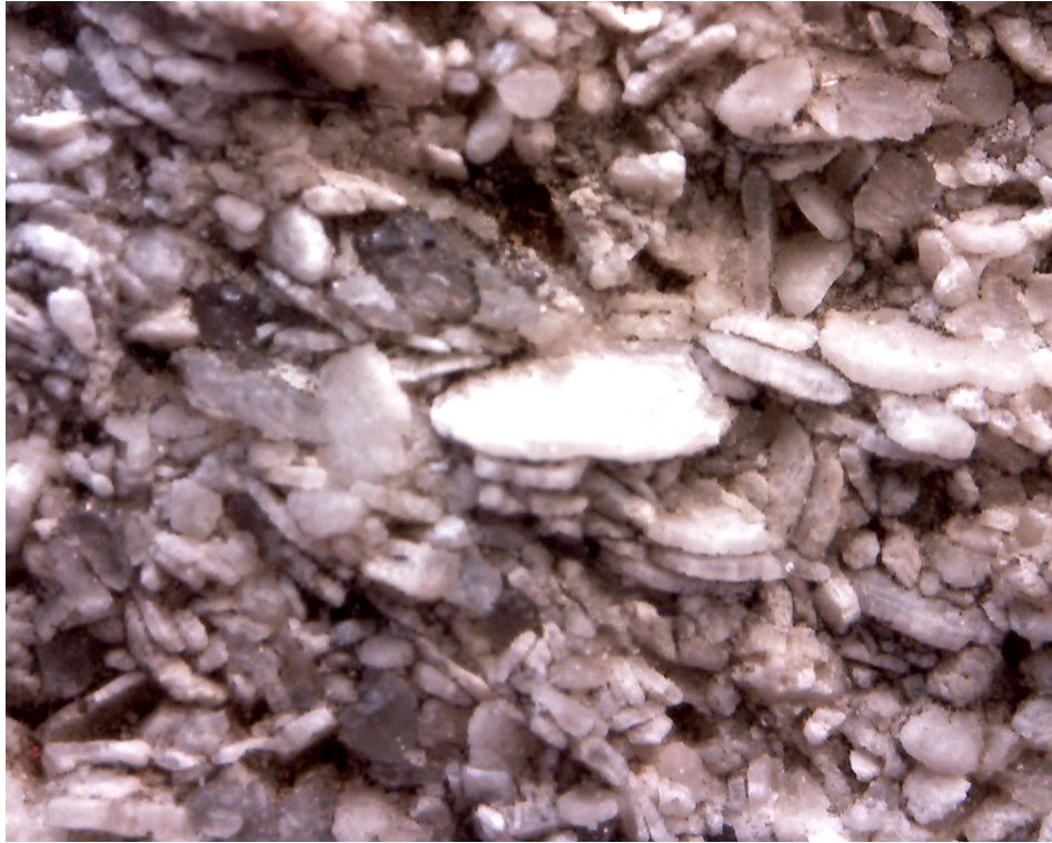
Obr. 23. Povrch vápence, před začátkem pokusu se silně kyselým deštěm, zvětšení 45x
