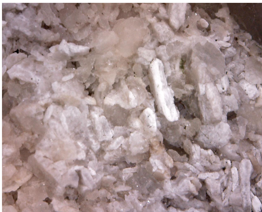
Obr. 31. Zvětšení 45x, po omytí tlakovou vodou. Na povrchu jsou zřetelné úbytky úlomků schránek živočichů, které nejsou natolik radikální jako u mikrotryskání, nicméně pořád jsou ztráty nepřipustné. Povrch je naprosto vyčištěný
