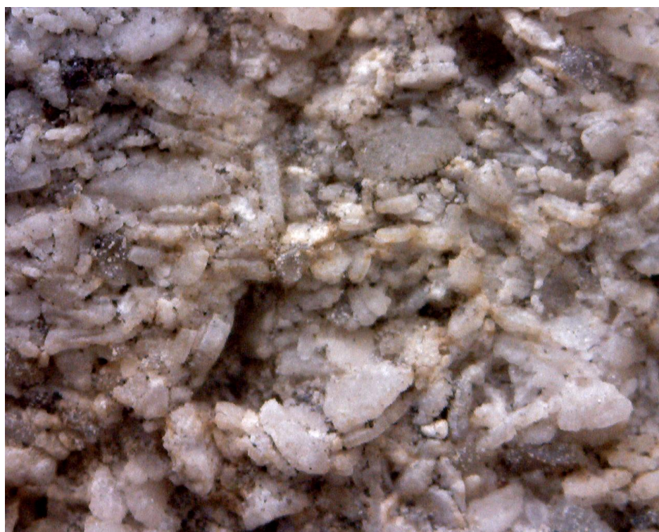
Obr. 39. Zvětšení 45x, povrch vystavený běžnému mírně kyselému dešti po 96 hodinách průtoku. Povrch je bez viditelných změn.
