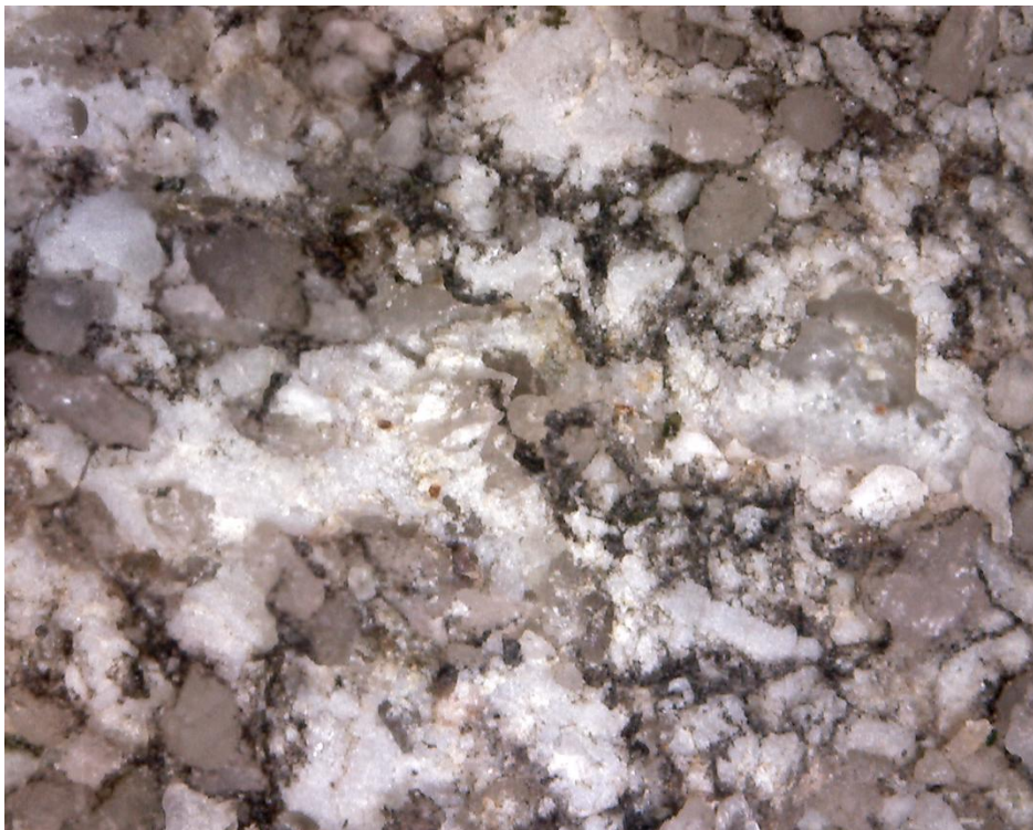
Obr. 24. Povrch vápence po 96 hodinách vystavení silně kyselému dešti. Na obrázku je při zvětšení 45x patná totální změna struktury a vzhledu povrchu
