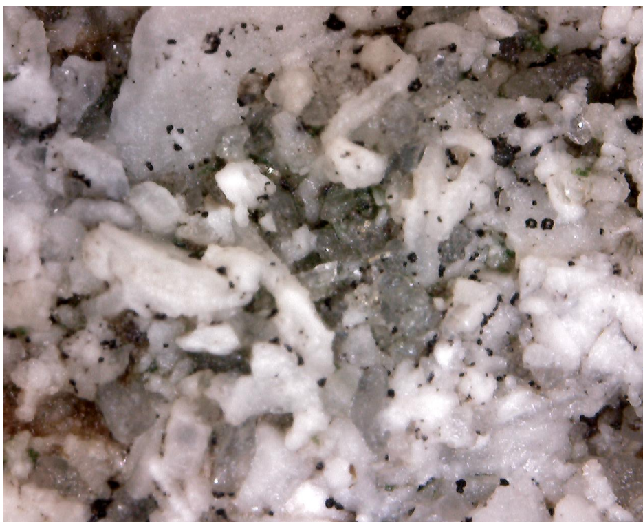
Obr. 35. Zvětšení 45x, po omytí tlakovou párou. Povrch je dostatečně vyčištěný, bez výraznějších úbytků schránek živočichů
