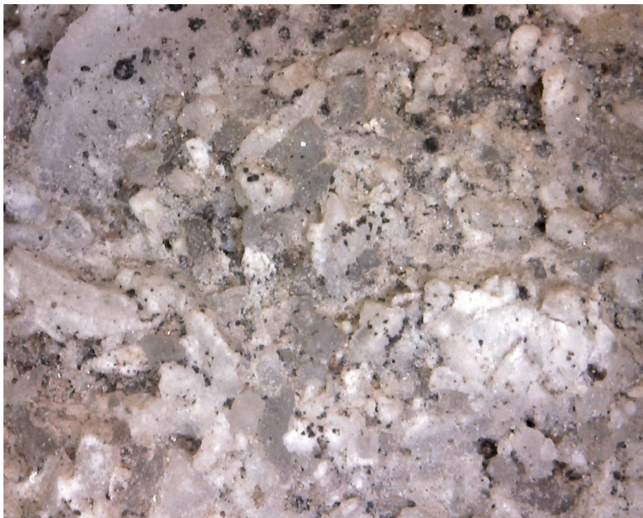
Obr. 27. Zvětšení 45x, po mikrotryskání. Povrch je znatelně vyčištěn a to i od velkého množství kalcitových úlomků schránek živočichů
