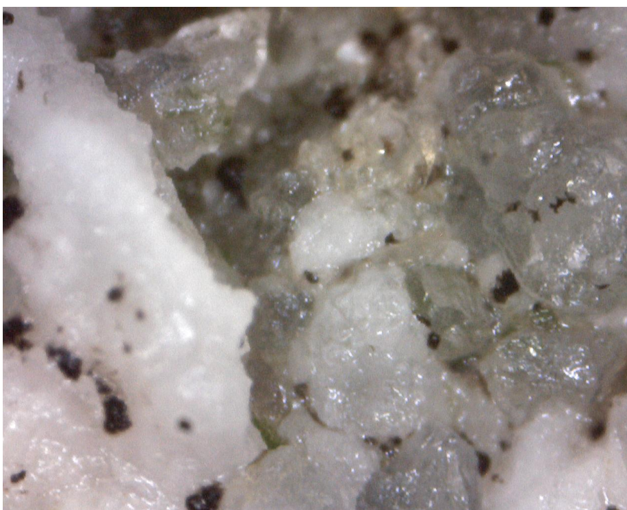
Obr. 37. Zvětšení 250x, po omytí tlakovou párou. Na snímku je patrný očištěný kámen s otevřeným povrchem, bez výrazného úbytku schránek nebo kalcitové výplně mezi nimi
