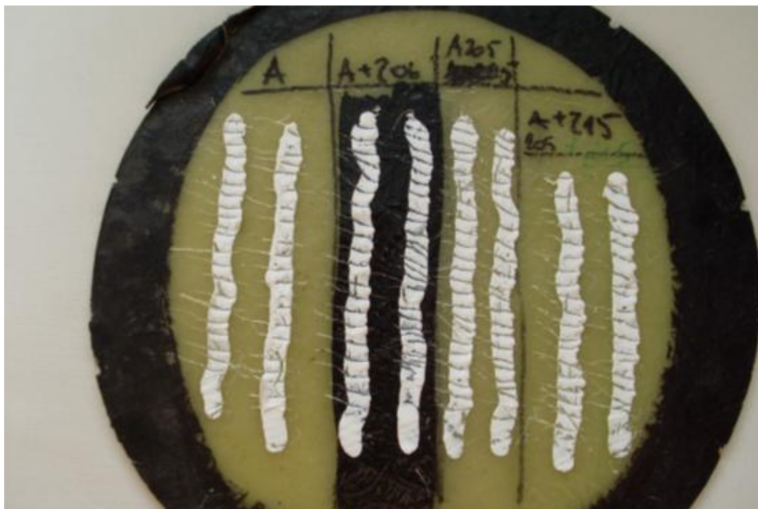
Obr. 18 Adhezní zkoušky na podkladu z laminátu
