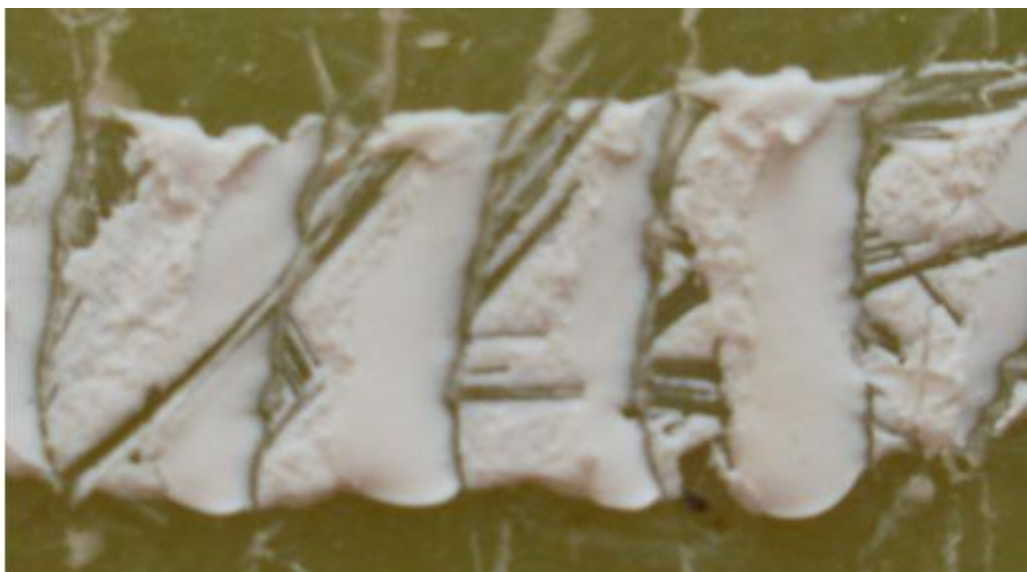
Obr. 19 Ukázka vytrhaných vláken z laminátu
