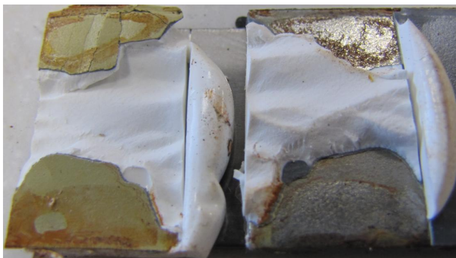
Obr. 25 Koroze na vzorku 2.4
