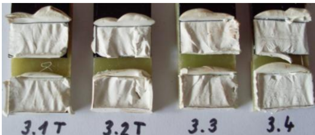
Obr. 27 Přetržené vzorky ze série 3.
