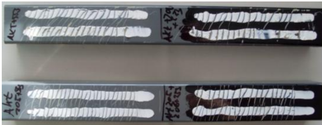
Obr. 20 Adhezní zkoušky na podkladu z plechu s barvou
