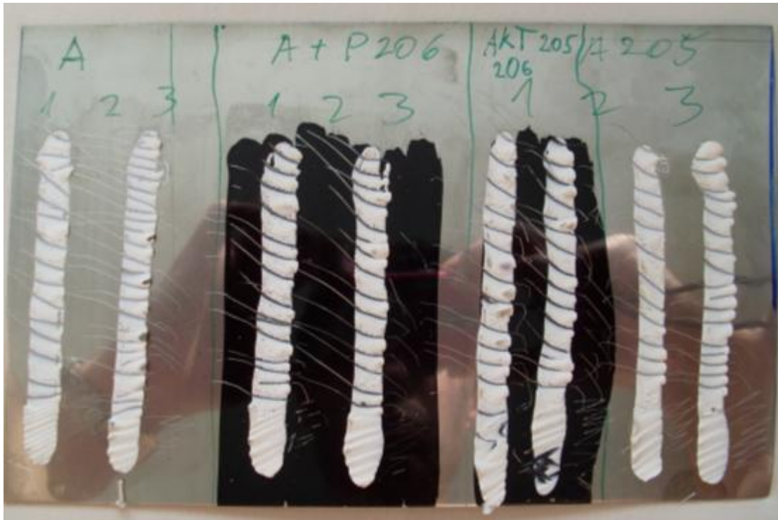
Obr. 17 Adhezní zkoušky na podkladu z nerezového plechu při 101 °C
