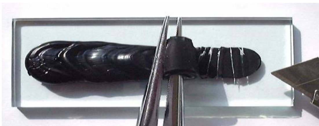
Obr. 12 Adhezní zkouška, převzato z [8]
