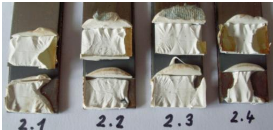
Obr. 24 Přetržené vzorky ze série 2.
