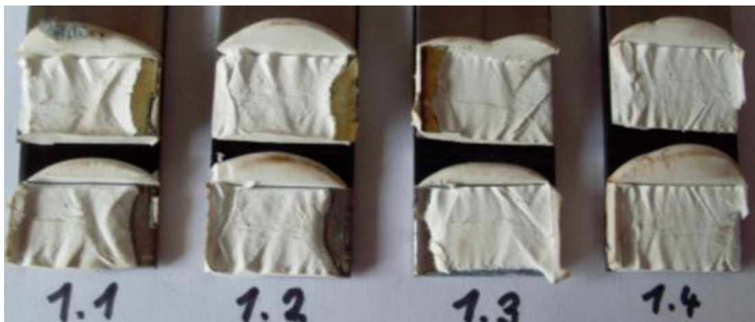
Obr. 22 Přetržené vzorky ze série 1.
