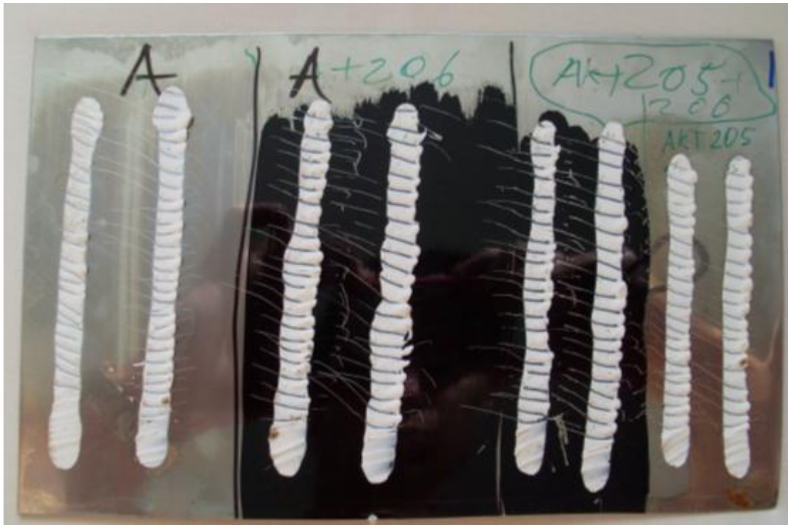
Obr. 16 Adhezní zkoušky na podkladu z nerezového plechu
