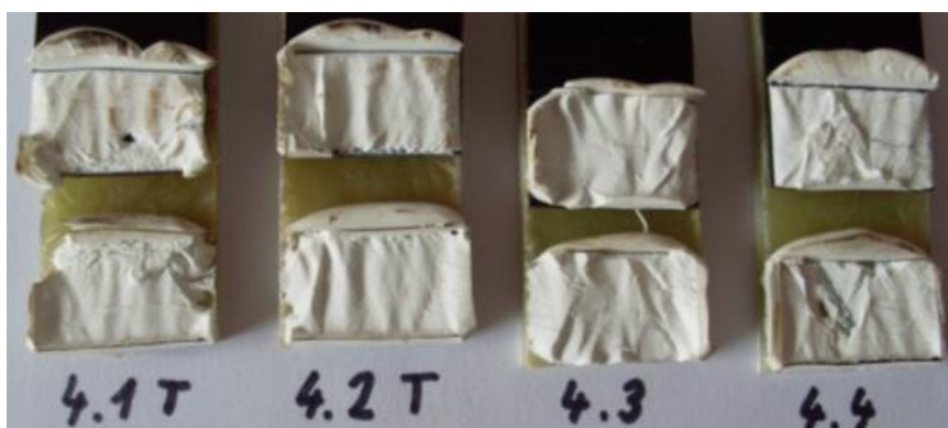
Obr. 28 Přetržené vzorky ze série 4.
