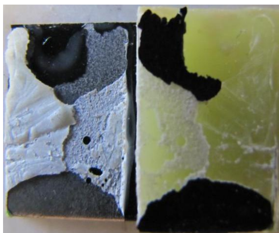
Obr. 21 - odtržení primeru na vzorku 1.3.
