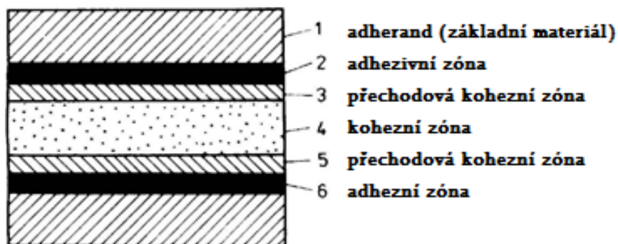
Obr. 2 - řez lepeným spojem [5]
