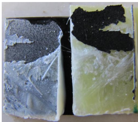
Obr. 30 - odtržení primeru na vzorku 3.4.
