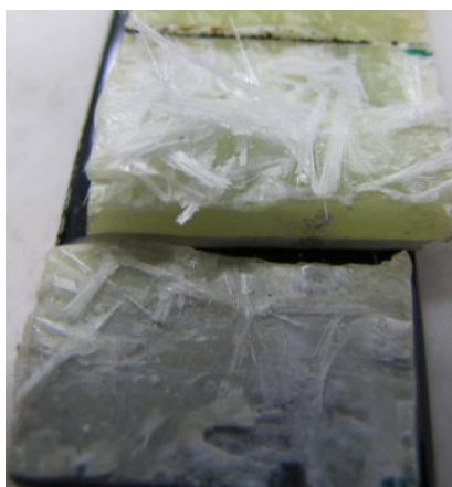
Obr. 29 - narušení základního materiálu na vzorku 3.3.
