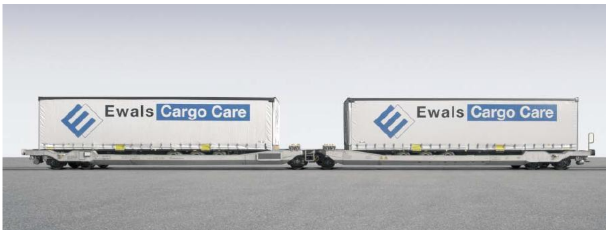
Obr. 8: Železniční vůz Sdggmrss – T (Twin)
