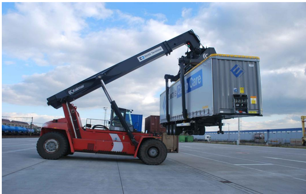
Obr. 7: Výsuvný stohovač s kleštinami při překládce sedlového návěsu
