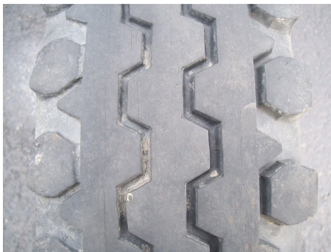
Obr. 20 – Následek špatné sbíhavosti
