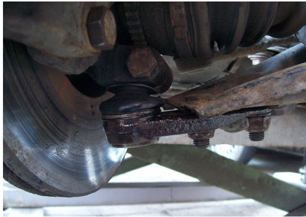
Obr. 3 – Namontovaný nový čep
