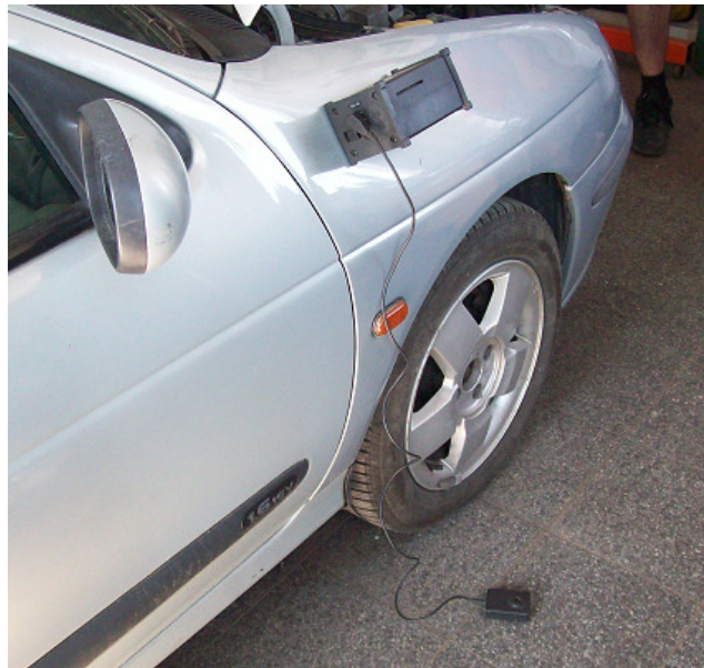
Obr. 18 – Dokmitový tester M- Tronic SDT 2000/U
