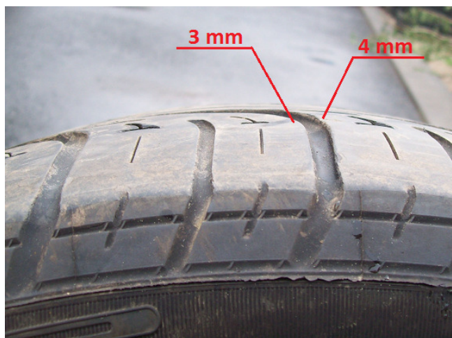
Obr. 19 – Ukázka rozdílu výšky dezénu
