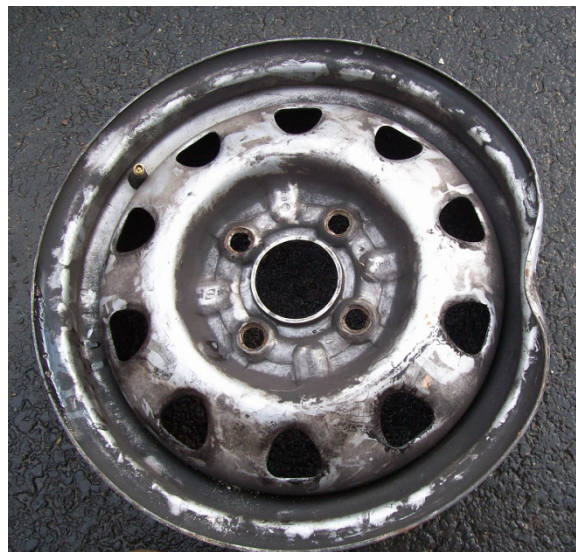
Obr. 14 – Příklad bouchlého ráfku
