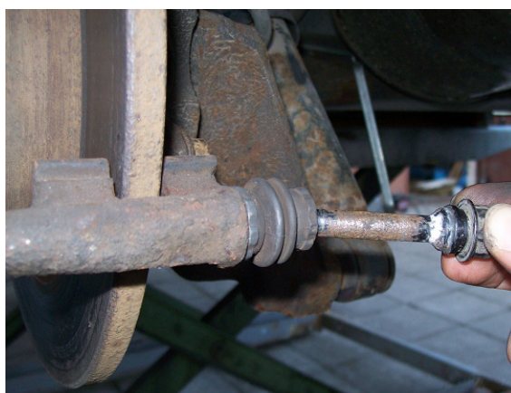
Obr. 6 – Zarezlé vodící čepy
