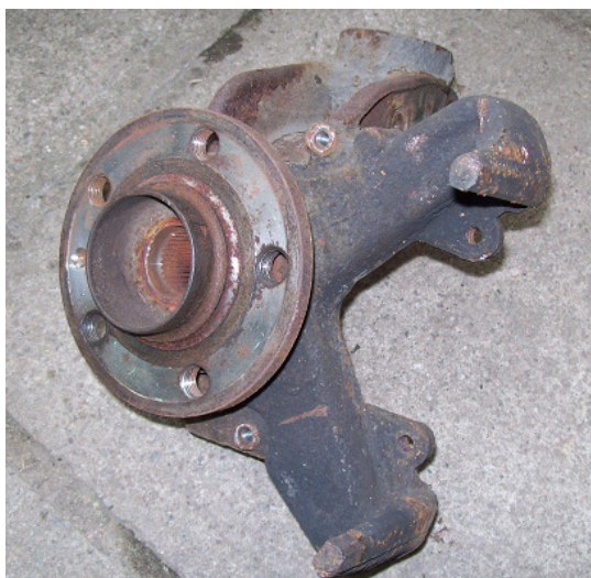
Obr. 7 – Těhlice (hlava ložiska)
