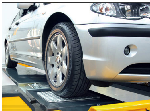
Obr. 21 – Detektor vůlí přední nápravy [8]
