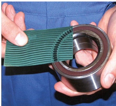
Obr. 30 – Ložisko s impulzním kolem [10]
