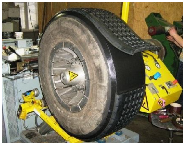
Obr. 27 – Protektorování za studena [9]
