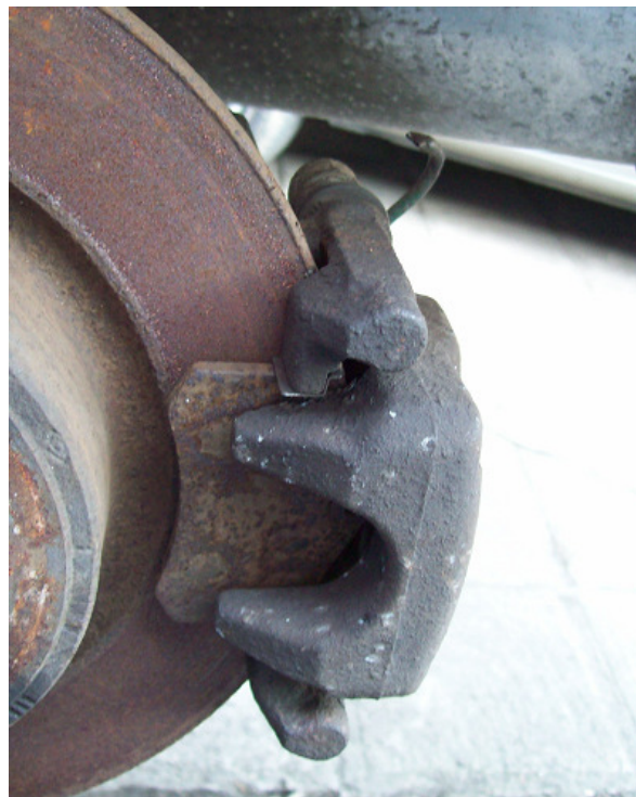
Obr. 4 – Přerušená brzdová hadička
