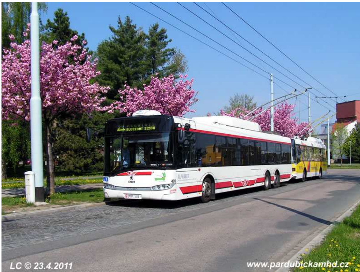
Obrázek č.5 Patnáctimetrový trolejbus Škoda 28Tr Solaris ve vozovém parku DPMP, a.s., v pozadí trolejbus standardní délky Škoda 21Tr
