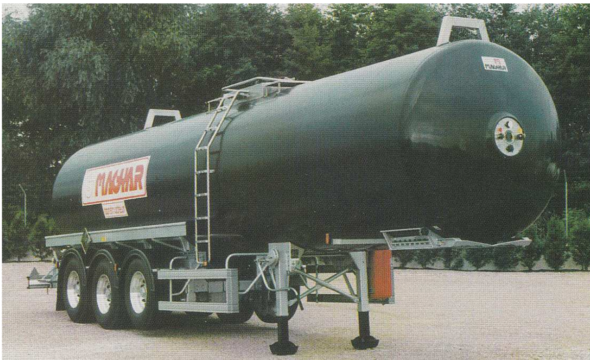
Obr 8: Cisternový návěs MAGYAR pro přepravu asfaltu Zdroj: Autorka
