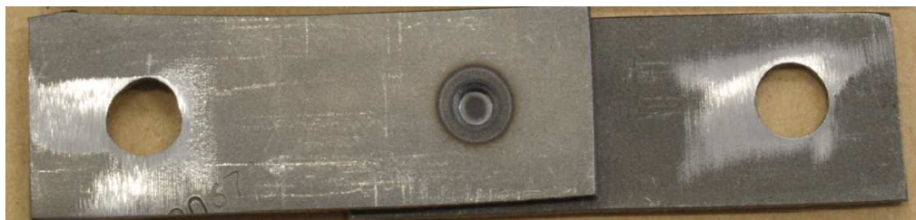
Obr. 23 Neporušený zkušební vzorek před dynamickou tahovou zkouškou
