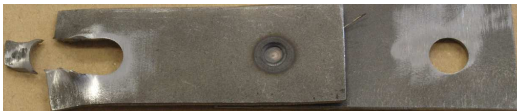
Obr. 24 Zkušební vzorek po dynamické tahové zkoušce zničen v oku
