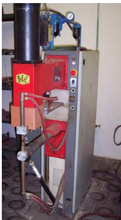
Obr. 10 Pneumatická bodová svářečka BP 20.12 [13]
