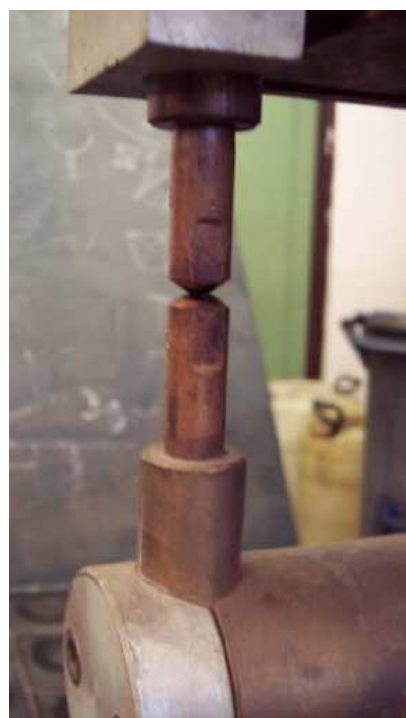
Obr. 11 Detail svařovacích elektrod [13]
