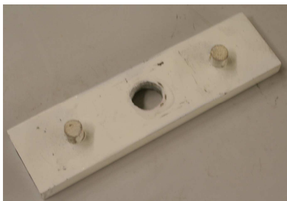
Obr. 8 Pomocný přípravek při svařování
