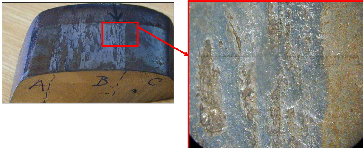
Obr. 29 – Analyzovaný řez srdcovky z austenitické manganové oceli (poškození povrchu)
