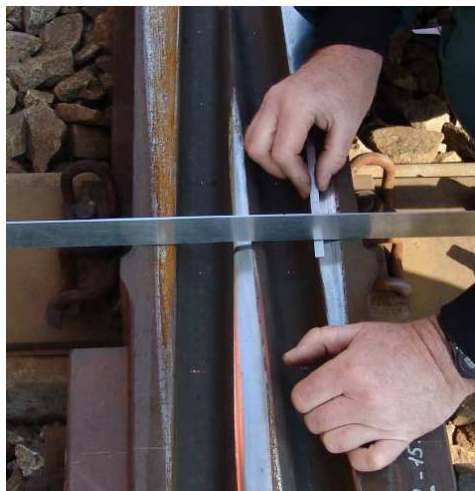
Obr.16 – Měření ocel. pravítkem a klínkem
