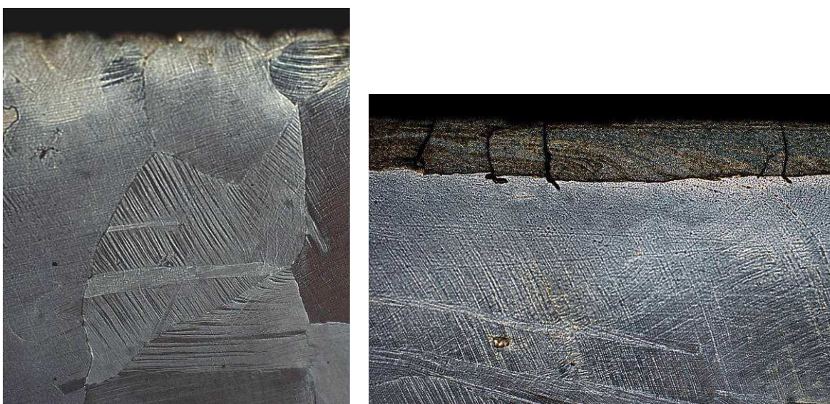
Obr. 31 – Rozdíl struktury povrchové vrstvy – - tvorba šupin vs. plynulý rozvoj deformace do profilu (zv. 250x)
