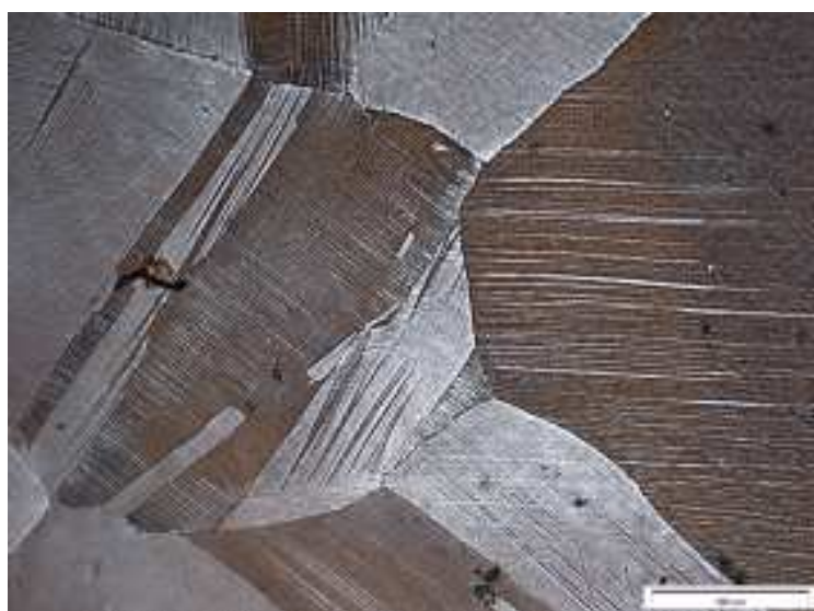
Obr. 30 – Postup deformace v závislosti na různých krystalografických orientacích zrna
